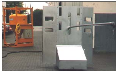
< Einfacher Lanzenwagen mit elektromotorisch verfahrenem Untergestell und 10 m - Spritzlanze.
